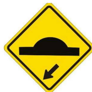
Placa A-18 (instalar junto à lombada)
